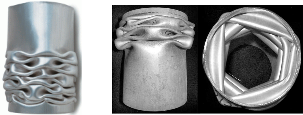
Resim 3. Alüminyumun şok emme kabiliyetinin uygulamam örneği kutucuklar Sürekli döküm tekniği ile üretilen AA5754 alaşımı başarı ile şok absorbe edebilen kutucukların imalatında kullanılmaktadır.
