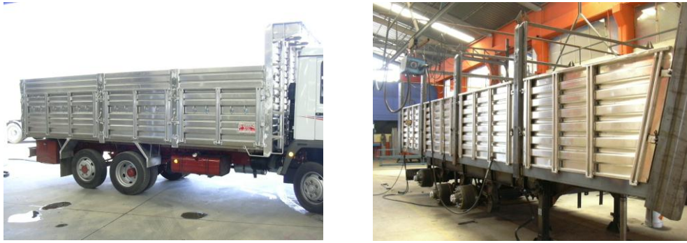
Resim 7. Sürekli döküm tekniği ile üretilmiş AA5754 alaşımından imal edilmiş kamyon kasası.
