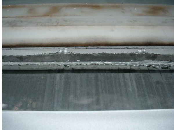
Resim 6. Seramik nozuldaki sorunlardan dolayı yüzeyinde band halinde izler barındıran bir dökme levha yüzeyi.
