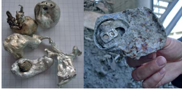
Dip küllerinden kazanılan erimiş alüminyum ve alüminyum içecek kutusu (Fotoğraf EAA)
